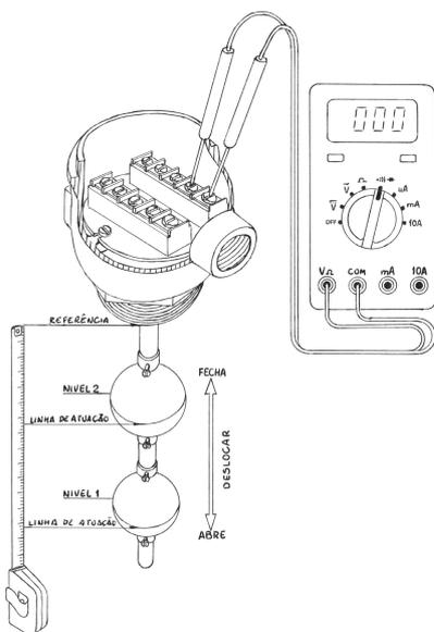
Refazer na bancada o Teste de Funcionamento, conforme manual. Se passar no teste, instalar a chave no tanque, conforme procedimento.
