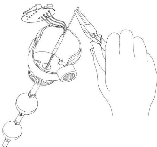
Com um alicate de bico puxar os sensores que estão fixados no fio guia (fio de aço inox).
