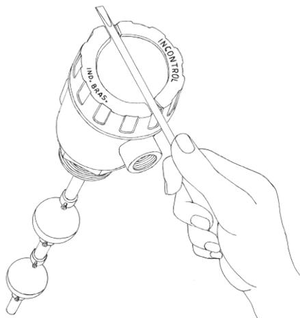
Desrosquear a tampa do cabeçote, podendo ser usado como alavanca a haste de uma chave de fenda. (se a conexão ao processo for rosca em polipropileno, tomar cuidado para não danificá-la. Fixar o cabeçote em uma morsa evitando o esforço mecânico na conexão).
