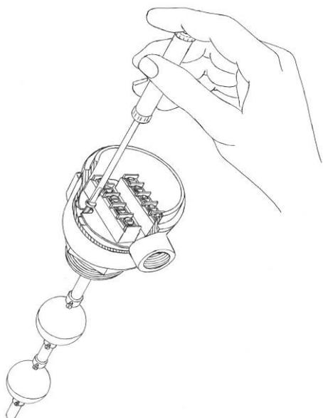
Dentro do cabeçote existe uma placa redonda de circuito eletrônico, onde estão acomodados os bornes. Desrosquear os 2 (dois) parafusos da placa deixando-a pendurada pelo fios do lado de fora do cabeçote.
