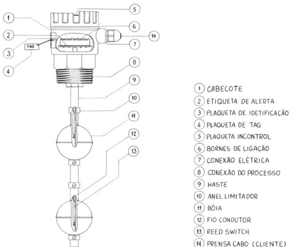
O exemplo citado possui uma lógica de controle de nível muito simples, porém poderíamos colocar um terceiro reed switch que funcionaria como um alarme extra alto. A chave de nível LC500 tem a possibilidade de ter 1, 2, 3, 4, ou 10 pontos de alarmes ou controle, dependendo da necessidade ou lógica de comando, fazendo com que a LC500 seja o controlador único de todo um processo.
