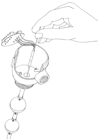
Recolocar o fio guia dentro da haste, isolar o tubo com silicone "neutro" e fixar a placa de bornes.
