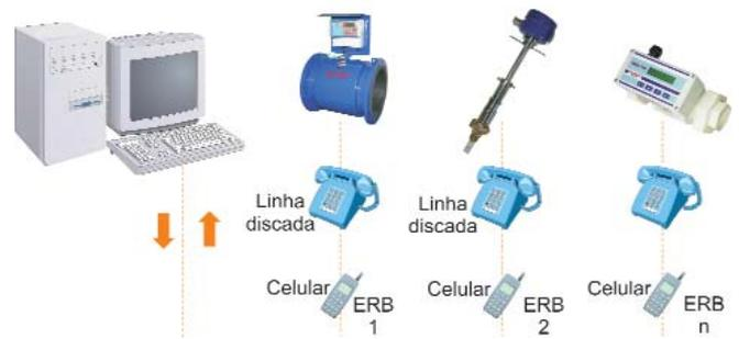
que permitem a transmissão dos dados da medição via telemetria (por rádio ou GPRS) para uma sala de controle, que pode disponibilizar os resultados de medição via internet.
