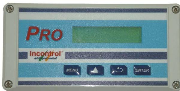
O módulo eletrônico PRO foi desenvolvido para operar como conversor integral ao medidor de vazão VMS, mas graças à sua excelente performance, passou a operar também com os demais medidores eletromagnéticos da Incontrol. É um conversor microprocessado com tecnologia SMT, quatro teclas de parametrização rápida e amigável e display de duas linhas e 16 caracteres, para indicação da vazão. De baixo custo e robusto, atende às necessidades específicas da medição de vazão, entre elas:
