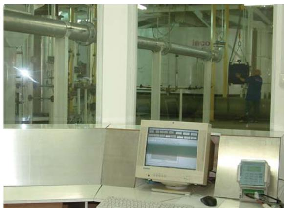
ção da densidade, assim como são medidas a temperatura, a umidade relativa do ar e a pressão barométrica, para compensar o nível de evaporação do volume da água sob medição. O Laboratório de Vazão Incontrol utiliza comunicação digital com protocolo Modbus para a transmissão de dados dos sensores para um computador onde são realizados os cálculos necessários, assim como para gerar os relatórios e certificados exigidos.
