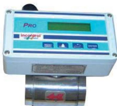
VMK com o conversor PRO acoplado
