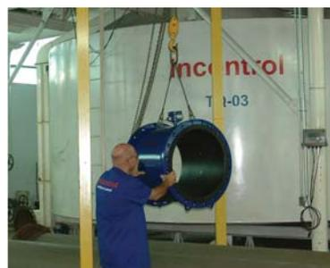
VMF no Laboratório de Vazão Incontrol
