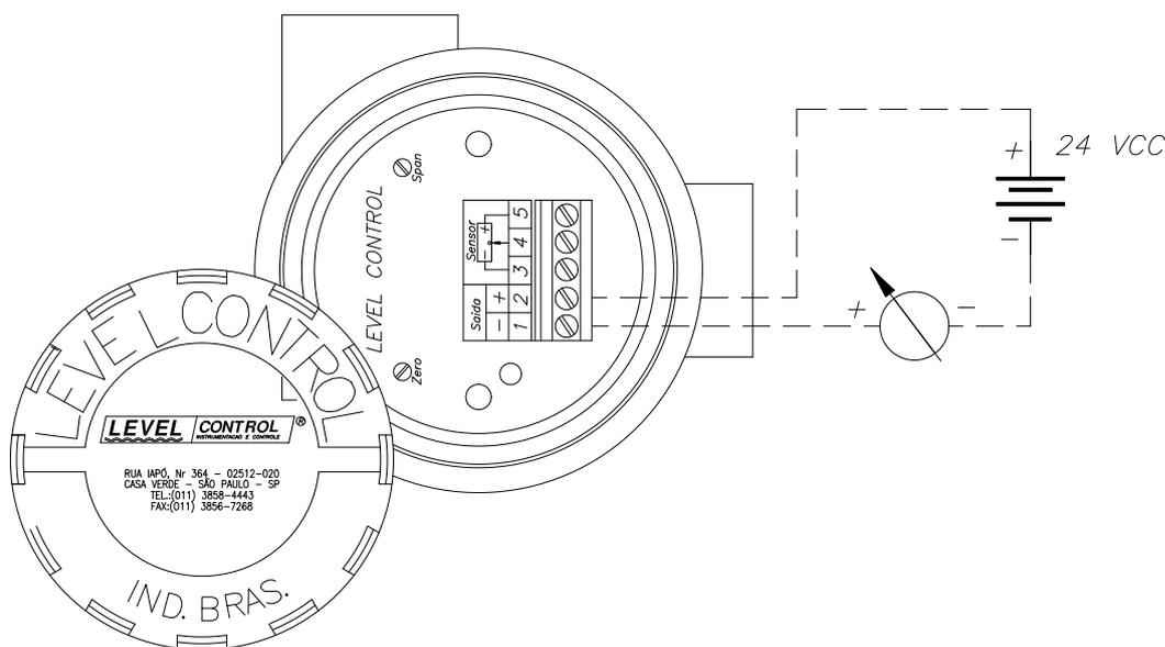
Ao mover a bóia para a ponta da haste, na posição de nível baixo no tanque, o amperímetro deverá indicar 4,000 mA. Movendo a bóia para o sentido oposto, na posição de nível alto, o amperímetro deverá indicar 20,00 mA. Caso tenha observado esses valores, o equipamento está pronto para ser definitivamente instalado.
